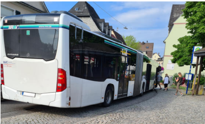
Die Bushaltestelle „Kirchgasse“ in der Hauptstraße Richtung Wiesbaden, genannt „Brückenplatz“. Wegen der Rundung der Haltebucht ist dem Gelenkbus kein bordparalleles Anfahren möglich. Die Ein- bzw. Aussteigenden können sich nicht barrierefrei bewegen.
